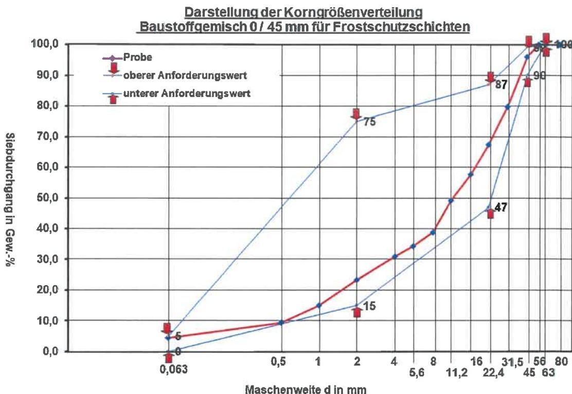
Abbildung 2: Darstellung der Korngrößenverteilung, Baustoffgemisch 0/45 mm für Schottertragschichten
